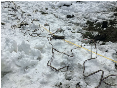
Série d'électrodes lors des études géoélectriques. Ces études permettent de dimensionner les amas de scories.
