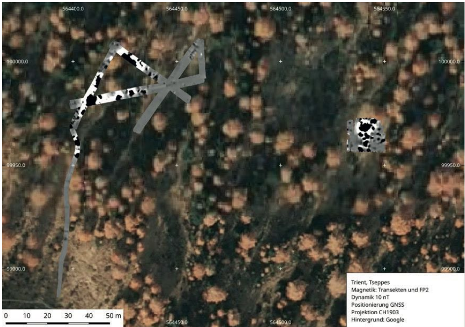
Figure 6 : Géolocalisation des transects d'étude géophysique du sous-sol des Tseppes, les taches noires témoignent la présence de métaux (potentiellement des dépôts de scories)
